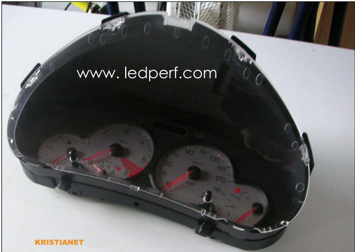
**Passo nº5 :** Utilizando a chave de fenda torx, desaperte os poucos parafusos na parte de trás do medidor :
