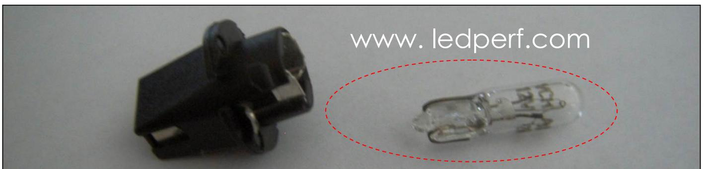
Depois só tem de colocar o T5 Efficacy led no suporte original em vez da lâmpada e voltar a colocar o suporte no medidor. Faça isso por todas as lâmpadas de sua escolha.
