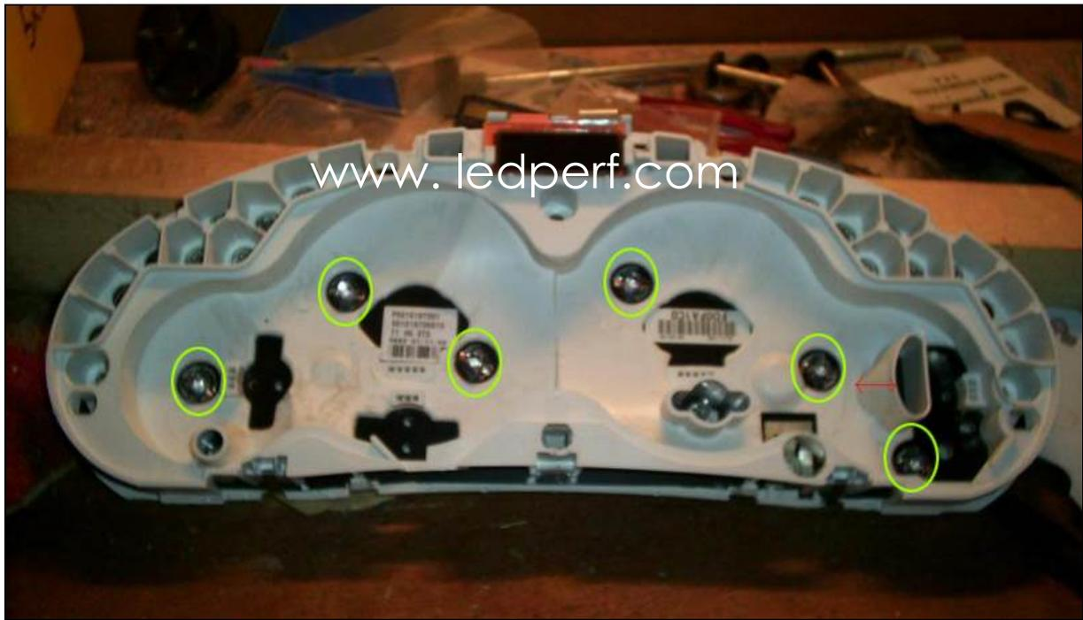
**Passo 7:** Olhe para a parte de trás do fundo do medidor na luz, para verificar se o fundo do medidor tem ou não uma camada clara de cor. Se as graduações forem perfeitamente transparentes, siga directamente para o passo 8. Caso contrário, siga as instruções abaixo.
