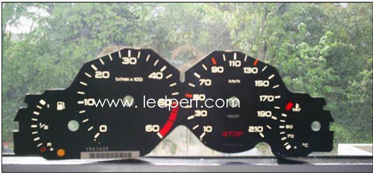
**Passo nº8 :** As lâmpadas W1,2W nos suportes pretos devem agora ser substituídas por leds T5 (azul, branco ou qualquer outra cor). Os leds são encaixados diretamente nos suportes originais. Não há, portanto, soldagem a ser feita e a mudança é muito rápida.
