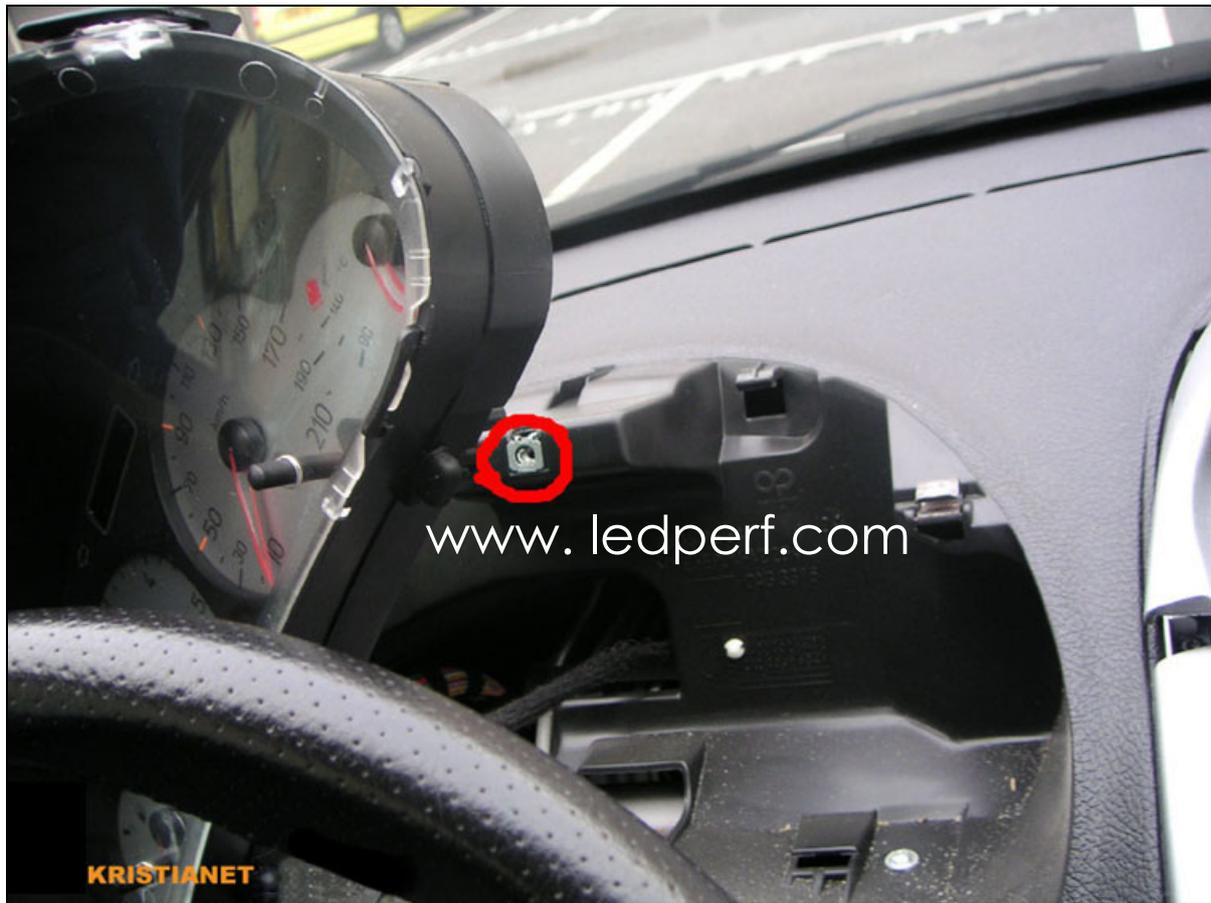
**Passo n°3 :** Desligue a ficha na parte de trás do fundo do contador utilizando a pequena alavanca preta :
